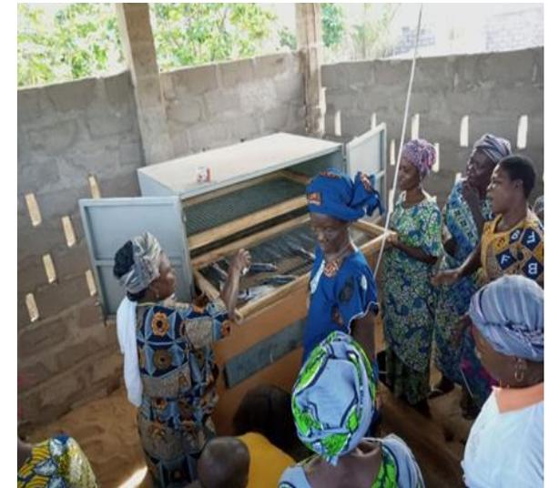
Le fumoir solaire permet d'économiser jusqu'à **4 kg de bois de chauffe** pour le fumage de poisson
